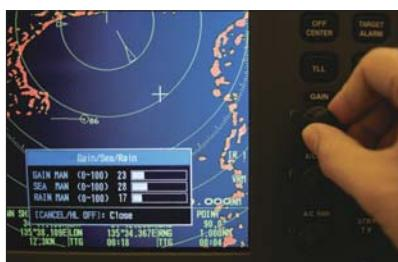
Χάρη στα προσεκτικά τοποθετημένα χειριστήρια στον μπροστινό πίνακα, μπορείτε να ζήσετε κορυφαία τεχνολογία ραντάρ με έναν απλοποιημένο σχεδιασμό λειτουργίας. Διαθέτει ένα πλήρως αυτόματο τρόπο λειτουργίας, καθώς και ειδικά περιστρεφόμενα κουμπιά για τη ρύθμιση GAIN/STC/FTC. Καθώς και ένα σύστημα μενού πάνω στην οθόνη με αναδιπλούμενα (drop-down) μενού το οποίο είναι εύκολο στον χειρισμό και με όλα τα χαρακτηριστικά ξεκάθαρα ορισμένα.
